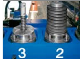
El tamaño máximo de herramienta es diámetro 88.9 mm
