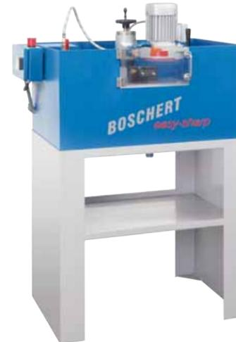
BOSCHERT ahora ofrece una máquina de afilado de herramientas perfecta para todos los clientes, incluso para aquellos que solo tengan una pequeña cantidad de herramientas. Con objeto de mantener la dureza del punzón y de la matriz durante el proceso de afilado, nuestra Easy Sharp va equipada con sistema de refrigeración.
