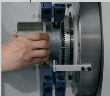
Particolare regolazione camme Cams setting detail
