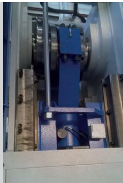
Gruppo cambio corsa-slitta Slide-stroke change unit
