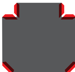
Slitta con sei guide a V.
