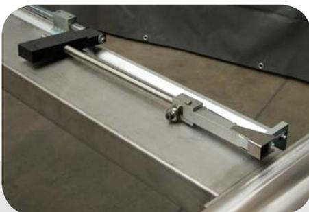
Der sehr robuste Anschlag sorgt für eine schnelle und automatische Positionierung. Verfahrweg 1000 oder 2000 mm.
