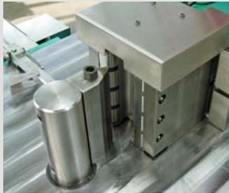
**Prisma mit integriertem Messsystem für automatisches Nachbiegen.**
