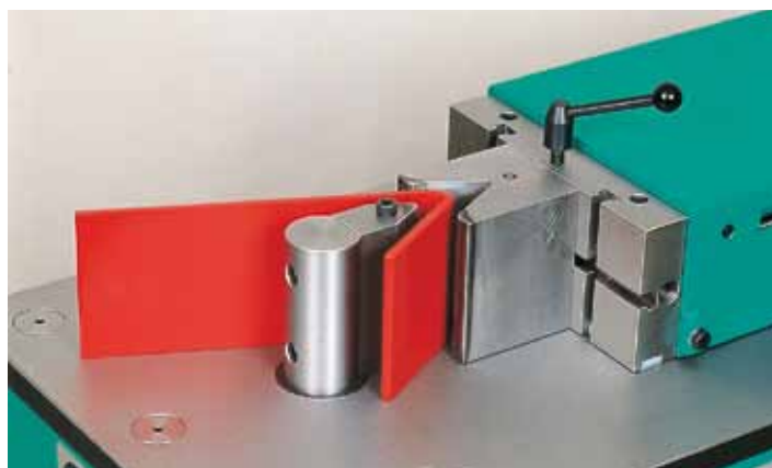
101 Prisma und Stempel 55° Vee-block and punch 55°
