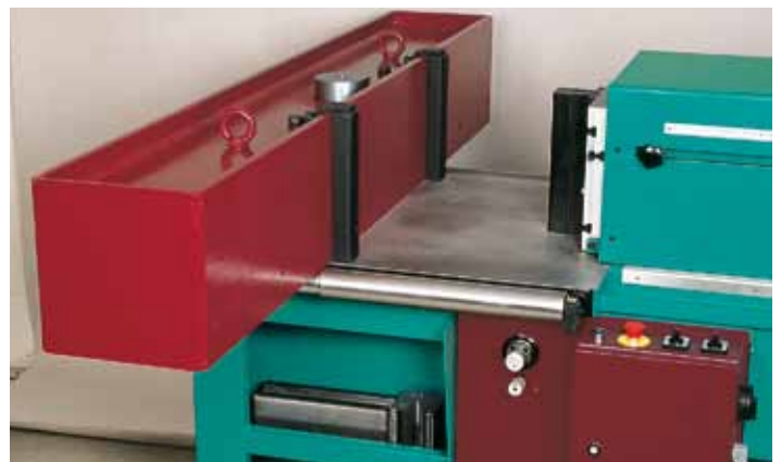
112 Richten bis HEA 260 Straightening up to HEA 260
