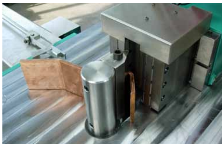
151 Prisma mit integriertem Messsystem für automatisches Nachbiegen Vee-block with integrated measuring system for automatic re-bend
