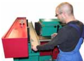
243 Richtarbeiten Straightening works
