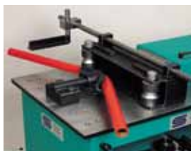
242 Rohre biegen Pipe bending
