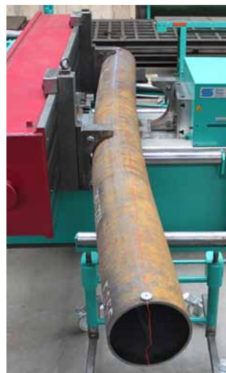
195 Rohre biegen bis ø400 mm Pipe bending up to ø400 mm
