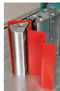
73 Dünnsblech biegen Bending thin sheet
