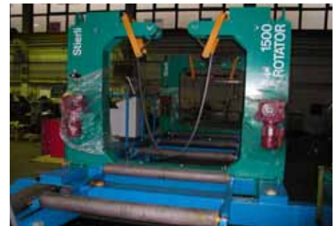
235 ROTATOR in Trägerschweissanlage integriert ROTATOR integrated in a beam line
