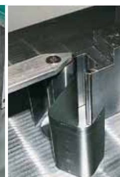
74 Dünnsblech biegen Bending thin sheet
