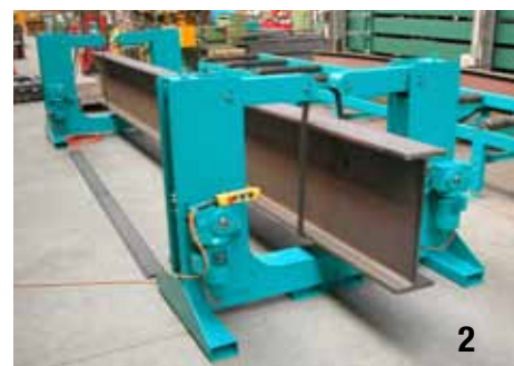
222 Arme schliessen automatisch Arms closes automatically
