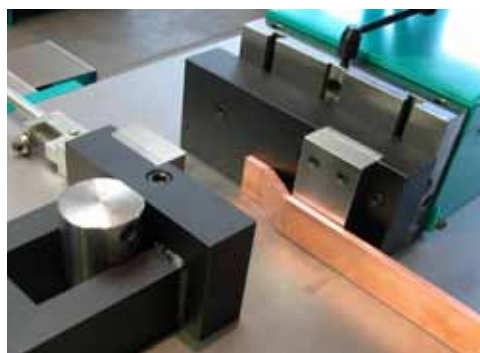
72 Absetzwerkzeug Step forming tool
