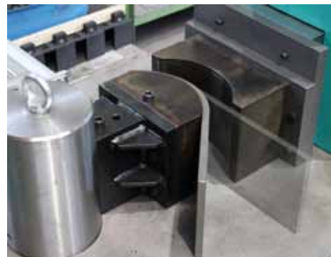
43 Biegen mit Formwerkzeugen - Pressbiegen Bending with forming tools - press bending
