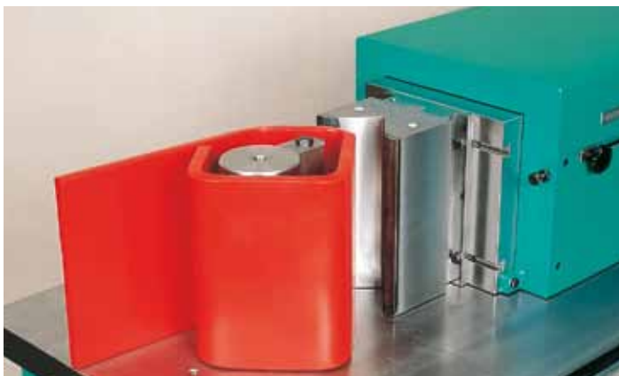
111 Biegen 300/30 Bending 12" x 1 1/4"
