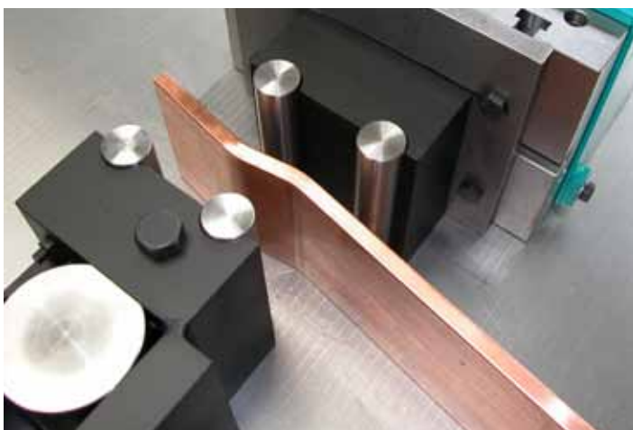
141 Absetzwerkzeug Step forming tool
