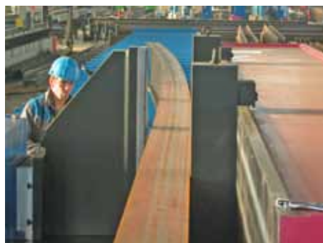
194 Richtpresse in Trägerfertigung integriert Cambering machine integrated in a beam line
