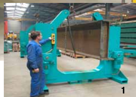
221 Träger absenken Lower the beam
